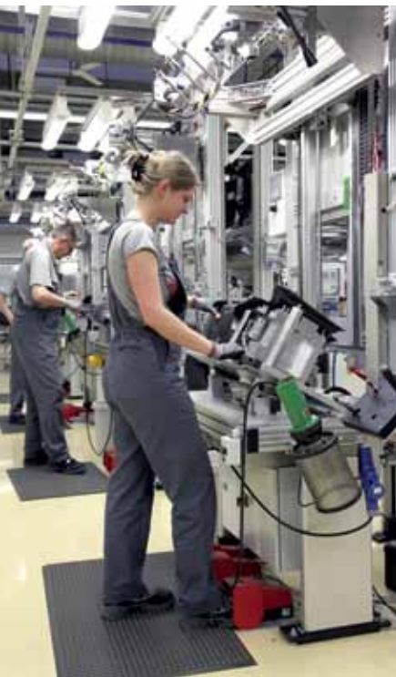
◀ In der Sattlerei schwenkt Nadine Stöhr per Fußpedal die Kaschier- vorrichtung nach hinten. Die Ver- stellbarkeit des Neigungswinkels verhindert einseitige Belastungen.
