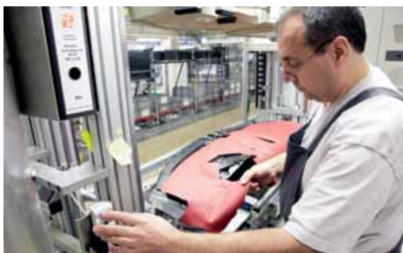
▲ Uwe Hägele bewegt das Trägerteil mit dem Zuschnitt per Knopfdruck in die passende Höhenposition.
