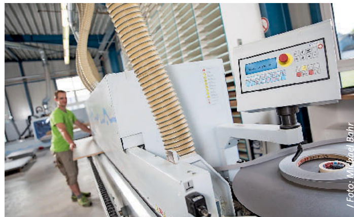
/ Die erste Kantenanleimmaschine mit einer Vorschubgeschwindigkeit von 8 m/min wurde vor Kurzem durch ein deutlich produktiveres Modell ersetzt.
